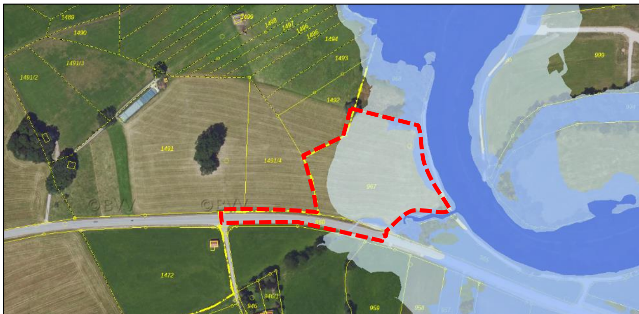
Abbildung 6: Hochwassergefahrenflächen HQ100 (hellblaue Fläche) und HQhäufig (dunkelblaue Fläche), o. M. (Auszug Bayernatlas© 2023 Bayerische Vermessungsverwaltung)
